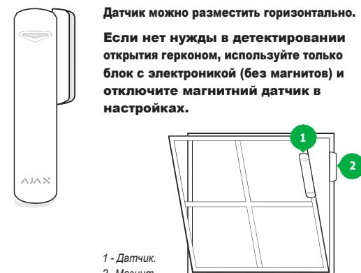
Датчик наклона определяет отклонение устройства в вертикальной плоскости более чем на 5°. DoorProtect Plus можно устанавливать на окна, в том числе мансардные, и ставить систему на охрану, когда они находятся в режиме проветривания (предварительно отключив магнитный датчик в настройках).
