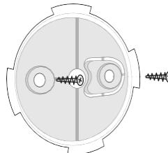
2. Наденьте сирену на панель SmartBracket и проверните по часовой стрелке — мигание светового индикатора подтвердит, что тэмпер сработал.
